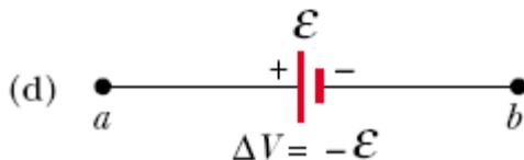
**SEGUNDA LEY:** La suma algebraica de los cambios de potencial a través de todos los elementos a lo largo de cualquier lazo (malla) de un circuito cerrado debe ser cero. Ésta regla surge de la conservación de la energía.
