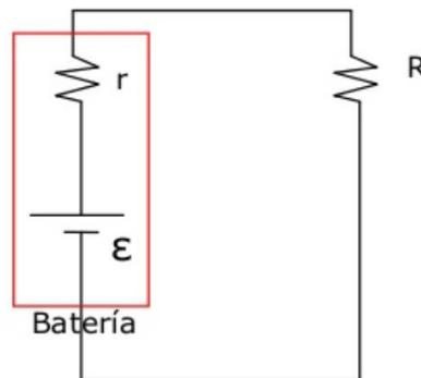
Al estar las resistencias en serie, la resistencia interna  $r$  y la otra  $R$ , se suman. Aplicando la ley de Ohm nos da la intensidad de corriente liberada por la batería:
