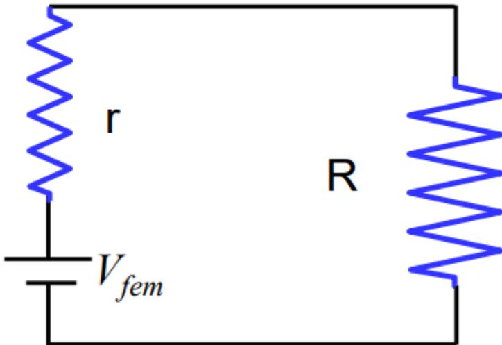
La fuente de fem realiza trabajo sobre la carga que la atraviesa, elevando su energía potencial en  $(q \Delta V)$ . Este trabajo por unidad de carga es suministrado por la fuerza electromotriz, fem, de la batería:
