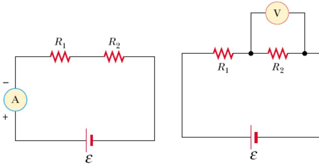
Amperímetro y voltímetro
