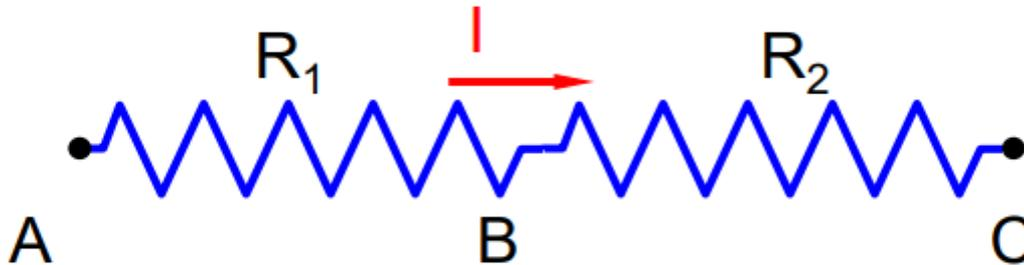
$$V_{AC} = V_{AB} + V_{BC}$$
