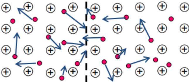
• = Los  $e^-$  libres en la red se comportan como las moléculas de un gas chocando con los átomos de la red cristalina del material
